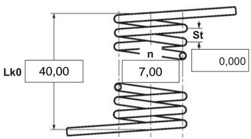
Federprüfung nach DIN ISO 2859/1 Prüfniveau II
