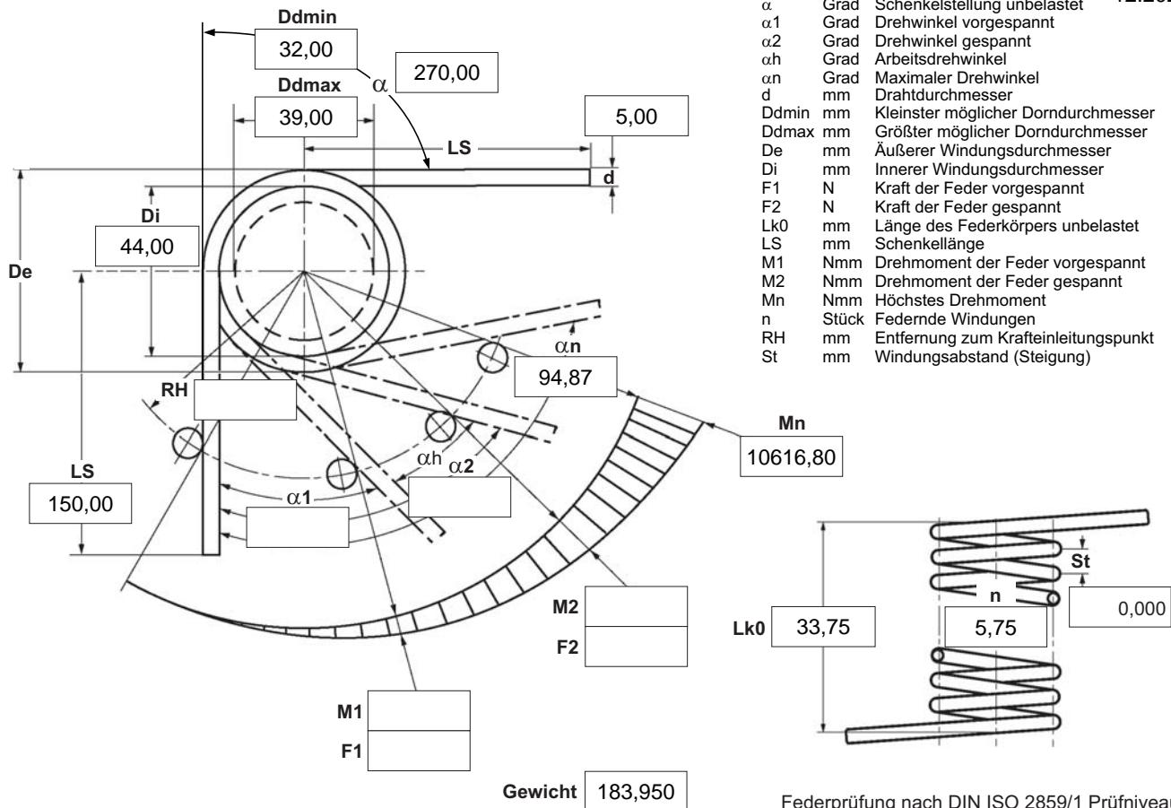
Federprüfung nach DIN ISO 2859/1 Prüfniveau II
