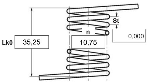
Federprüfung nach DIN ISO 2859/1 Prüfniveau II
