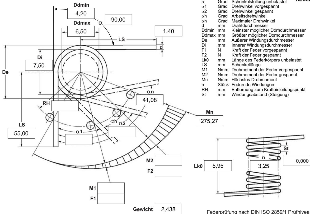
Federprüfung nach DIN ISO 2859/1 Prüfniveau II
