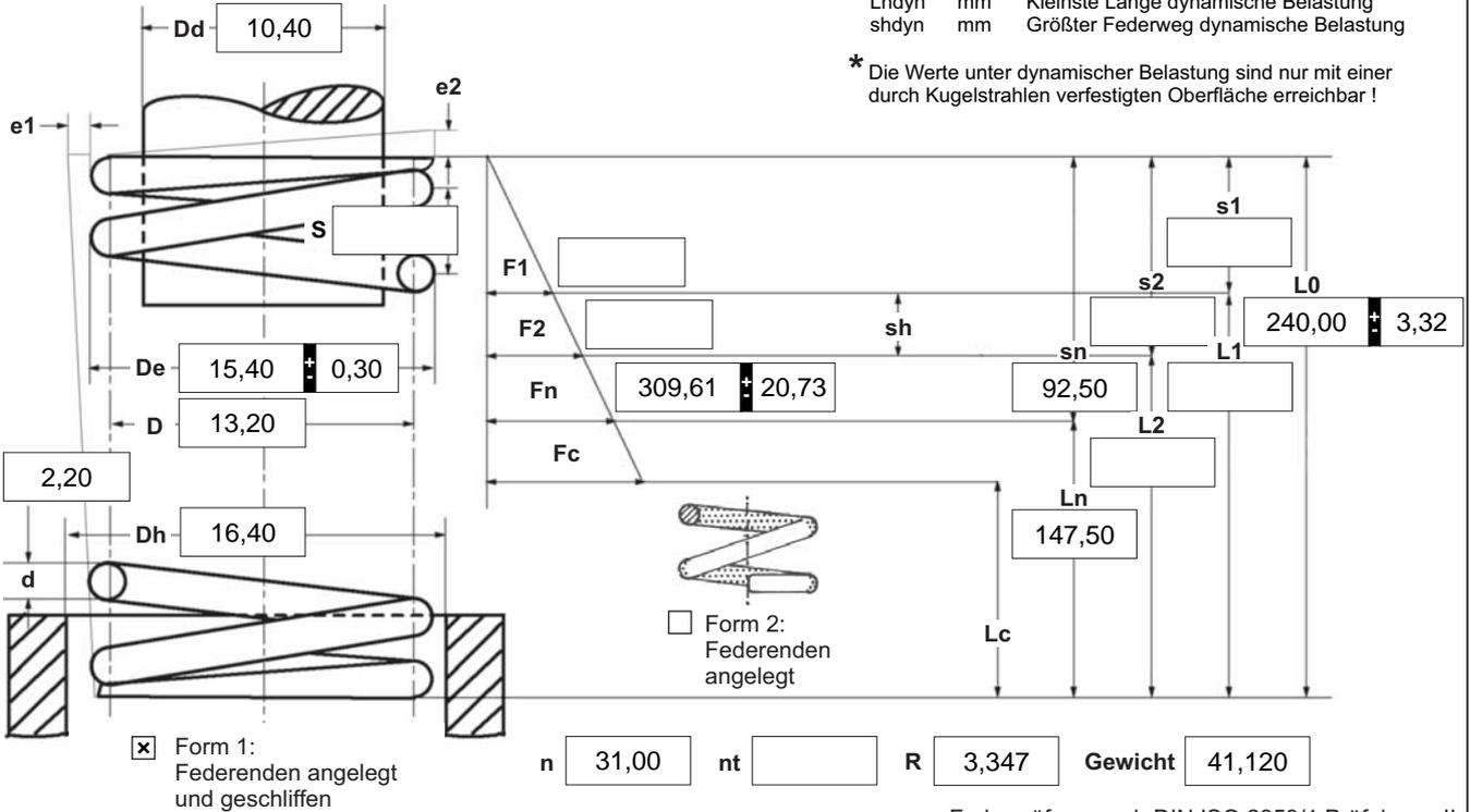
Federprüfung nach DIN ISO 2859/1 Prüfniveau II
