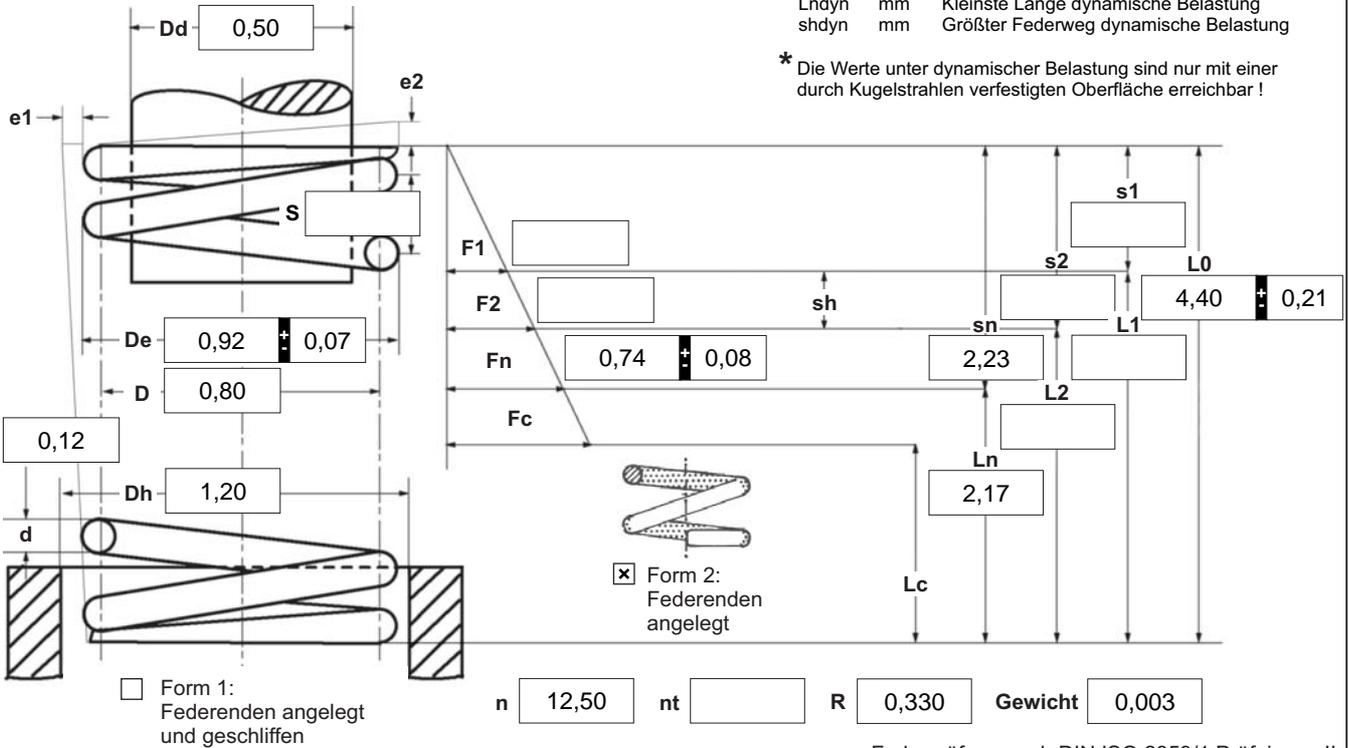
\* Die Werte unter dynamischer Belastung sind nur mit einer durch Kugelstrahlen verfestigten Oberfläche erreichbar !
